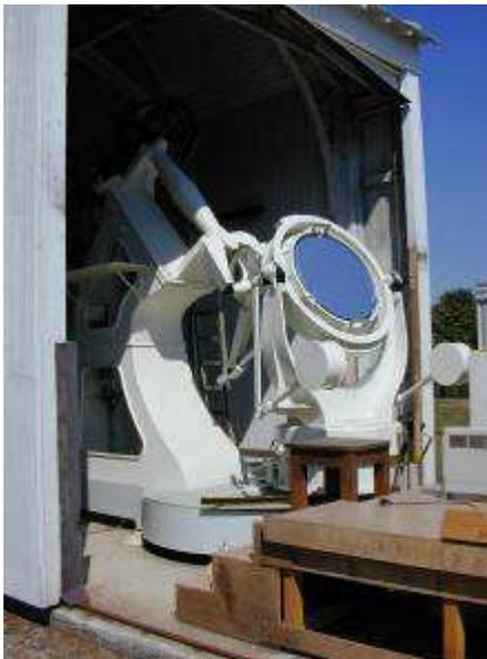
**R. Michard conçoit le magnétographe en 1962. Une grille de Hale devant la fente d'entrée transmettent alternativement la lumière polarisée droite et gauche. Les plaques étaient mesurées par le lambdamètre imaginé par Jean Rayrole. Dès 1967, Rayrole perfectionne le magnétographe. Ce travail important amènera J. Rayrole à imaginer le futur télescope Thémis.**
